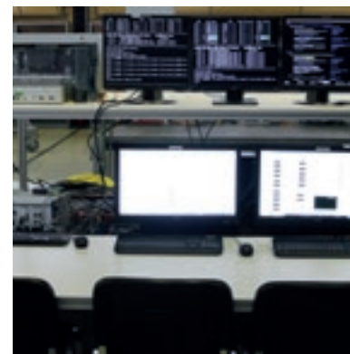
Hardware in the Loop Prüfstand für das EMS
