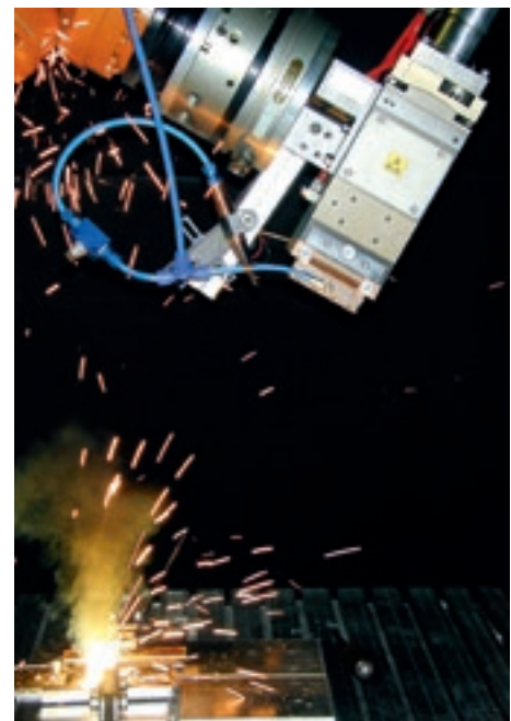
Elektrische Kontaktierung von Lithium-Ionen-Zellen mittels Laserstrahlung.
