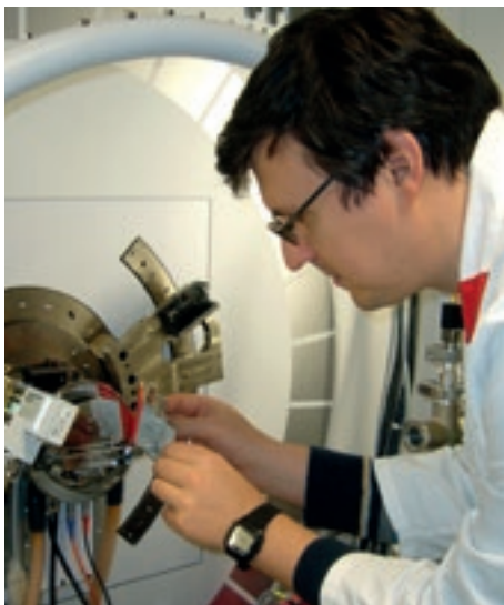
Vorbereiten einer Messung einer Pouchbag-Zelle am Röntgendiffraktometer
