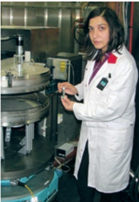
Dr. Neelima Paul ist gerade dabei eine Li-Ion-Zelle (bereitgestellt bei VOLKSWAGEN VARTA Microbattery) in den Probenhalter des hochauflösenden Neutronendiffraktometers SPODI zu platzieren.
