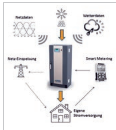
Funktionsweise eines netzdienlichen Batteriespeichers
