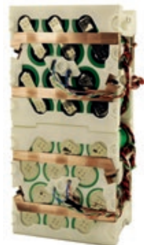
Teilmodulaufbau für thermische Messungen
