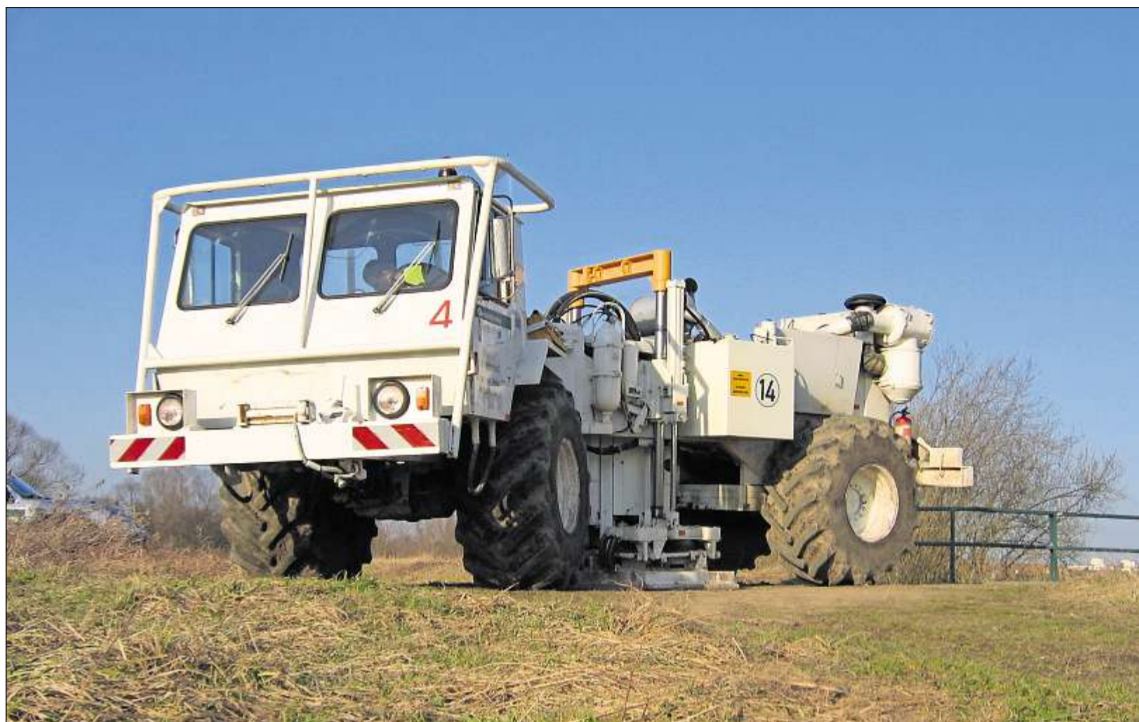
Eines der Fahrzeuge, in denen sich die empfindlichen Messgeräte für die Bodenuntersuchungen befinden, bringt etwa 25 Tonnen auf die Waage. Foto: red
